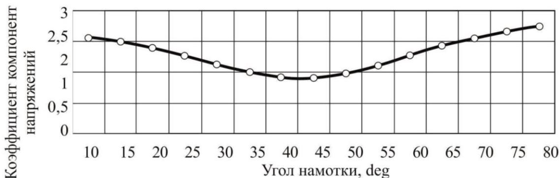
Рис. 4. График зависимости коэффициента компонент напряжений от угла намотки
