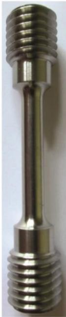
Рис. 1. Цилиндрический образец для механических испытаний на одноосное растяжение
