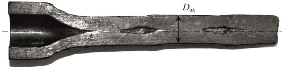
Рис. 3. Деформированный образец
