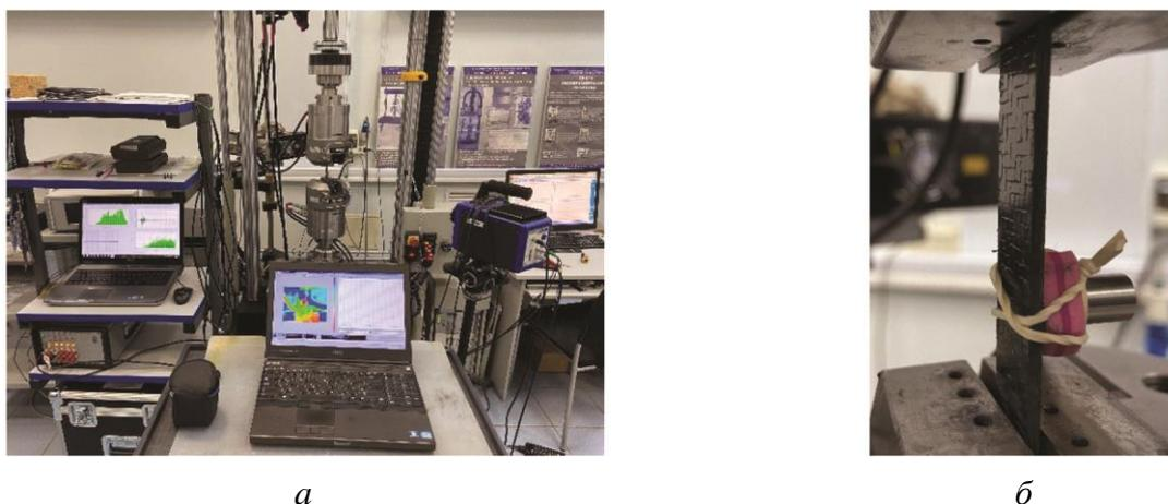
Рис. 1. Фотографии диагностических систем и испытательной машины (а) и образца, установленного в захваты испытательной системы, с датчиком регистрации сигналов акустической эмиссии (б)
