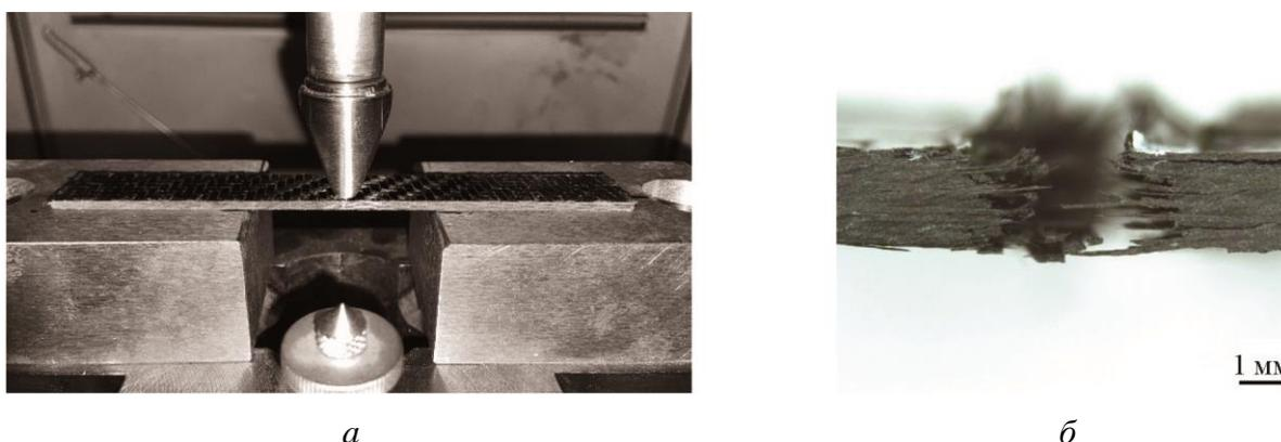
Рис. 2. Фотографии установленного образца (а) и образца после проведения испытания на удар падающим грузом по схеме трехточечного изгиба (б)
