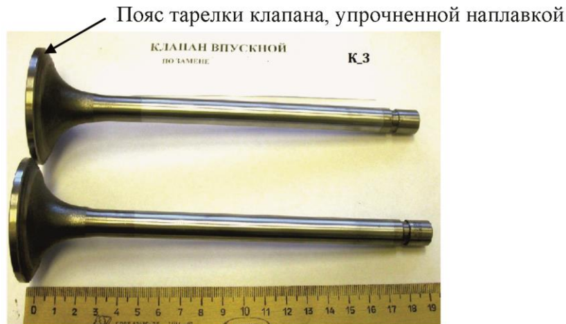
Рис. 1. Внешний вид клапана, упрочненный наплавкой
