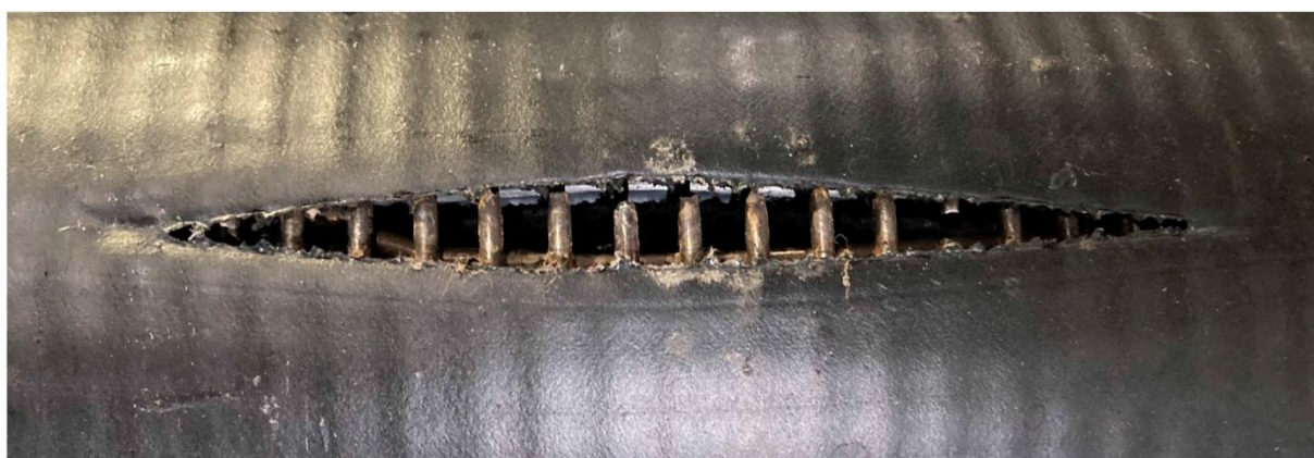
Рис. 5. Результаты испытаний ЖПАТ (образец 1): график изменения давления (а); область разрушения (б)
