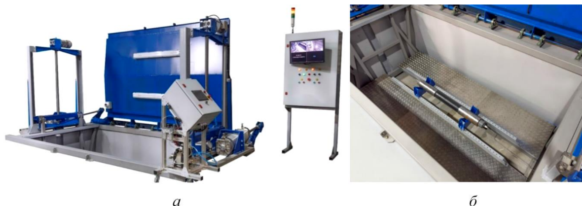
Рис. 4. Установка для проведения гидравлических испытаний до разрушения: внешний вид камеры со шкафом управления и насосом (а); камера испытания образцов на максимальное разрушающее давление (б)
