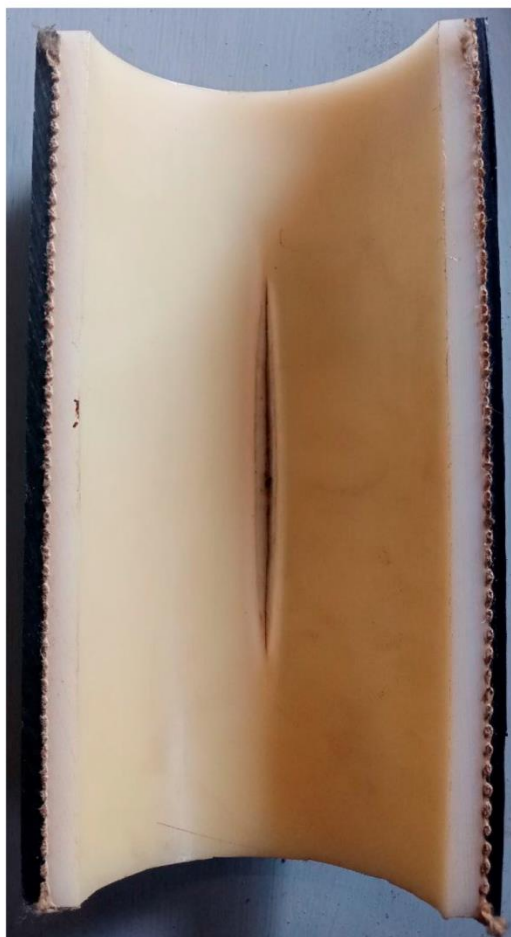
Рис. 7. Результаты испытаний ГПАТ (образец 2): график изменения давления ( а ); область разрушения в продольном направлении ( б )
