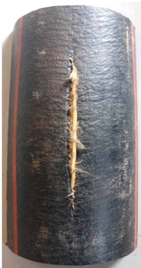
Рис. 7. Результаты испытаний ГПАТ (образец 2): график изменения давления ( а ); область разрушения в продольном направлении ( б )
