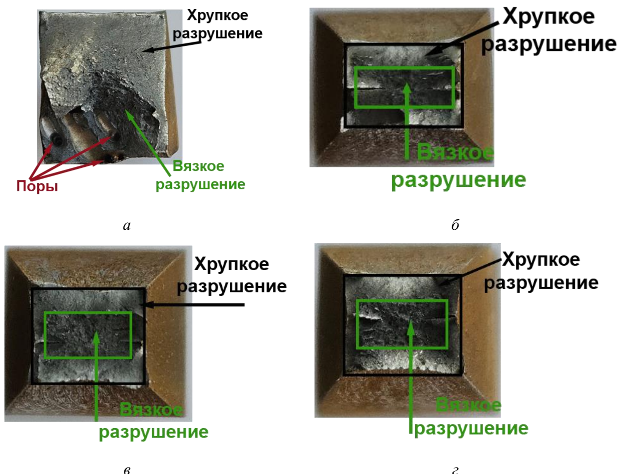
Рис. 10. Поверхности разрушения образцов стали 09Г2С после испытаний на растяжение: без ОТП (а); ОТП 100 (б); ОТП 75 (в); ОТП 50 (з)
