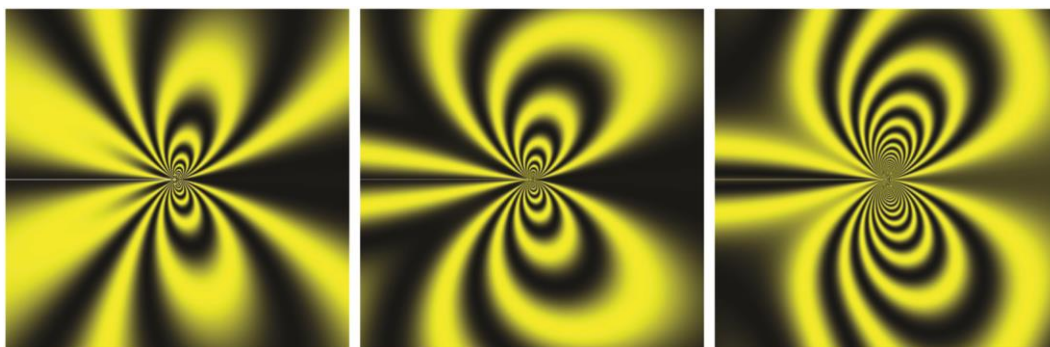
Рис. 6. Теоретически реконструированное поле изохроматических полос, полученное с помощью различного числа слагаемых в полном асимптотическом разложении М. Уильямса
