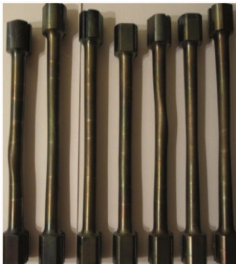
Рис. 9. Трубчатые образцы (внутренний диаметр 14 мм, наружный диаметр 16,1 мм и рабочая длина 130 мм) из титанового сплава ВТ1–0 после испытаний на ползучесть при 550 °С
