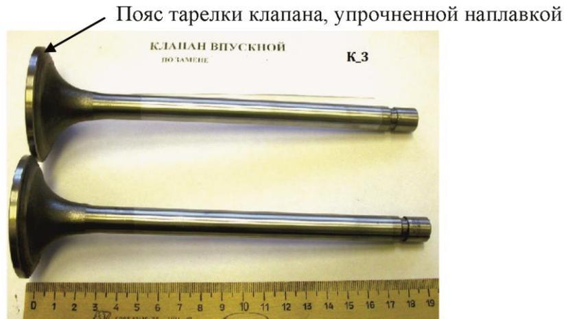
Рис. 1. Внешний вид клапана, упрочненный наплавкой
