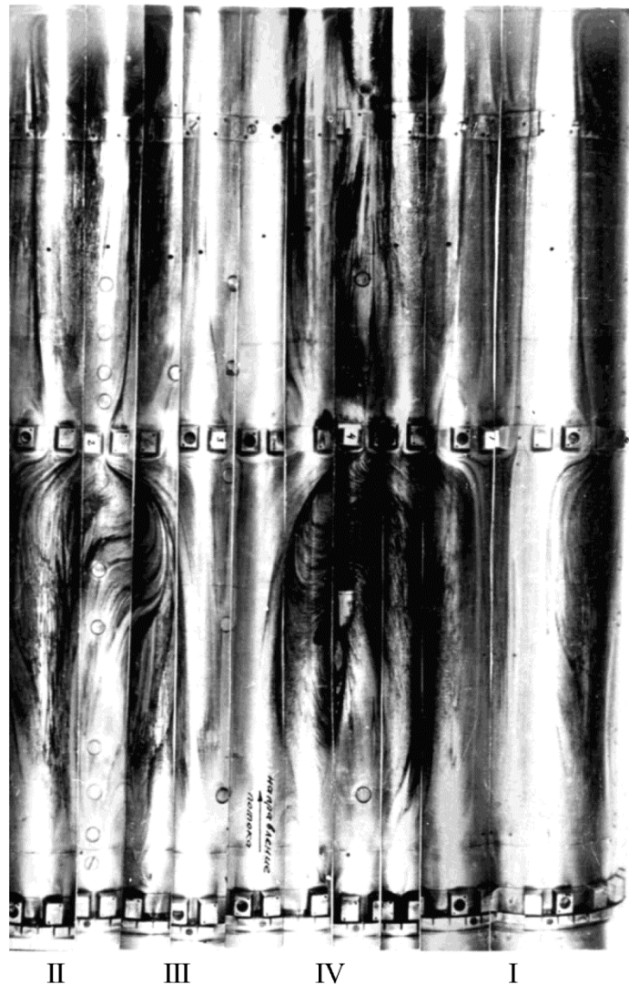
Рис. 2. Картина течения газа в кольцевом зазоре \bar{P} = 0,52 ; \bar{S}_{обт,1} = 80 \% ; \bar{S}_{обт,2} = 56 \%
