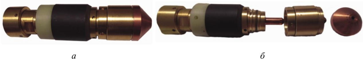
Рис. 5. Опытная модель плазмотрона ПМВР-9.1: а – в сборе; б – элементы конструкции
