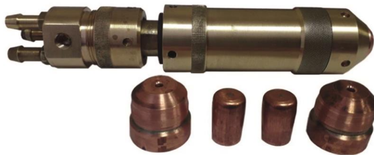
Рис. 2. Опытно-промышленная модель плазмотрона ПМВР-5.1 с элементами соплового узла
