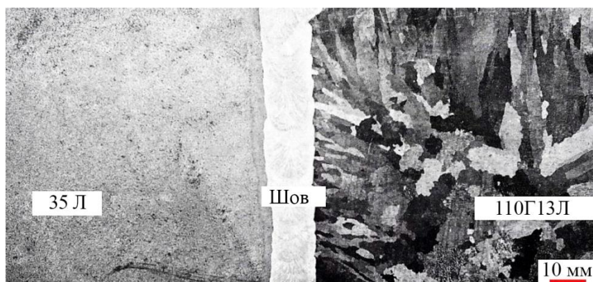
Рис. 2. Макроструктура сварного соединения разнородных сталей, выполненного с использованием узкощелевой разделки
