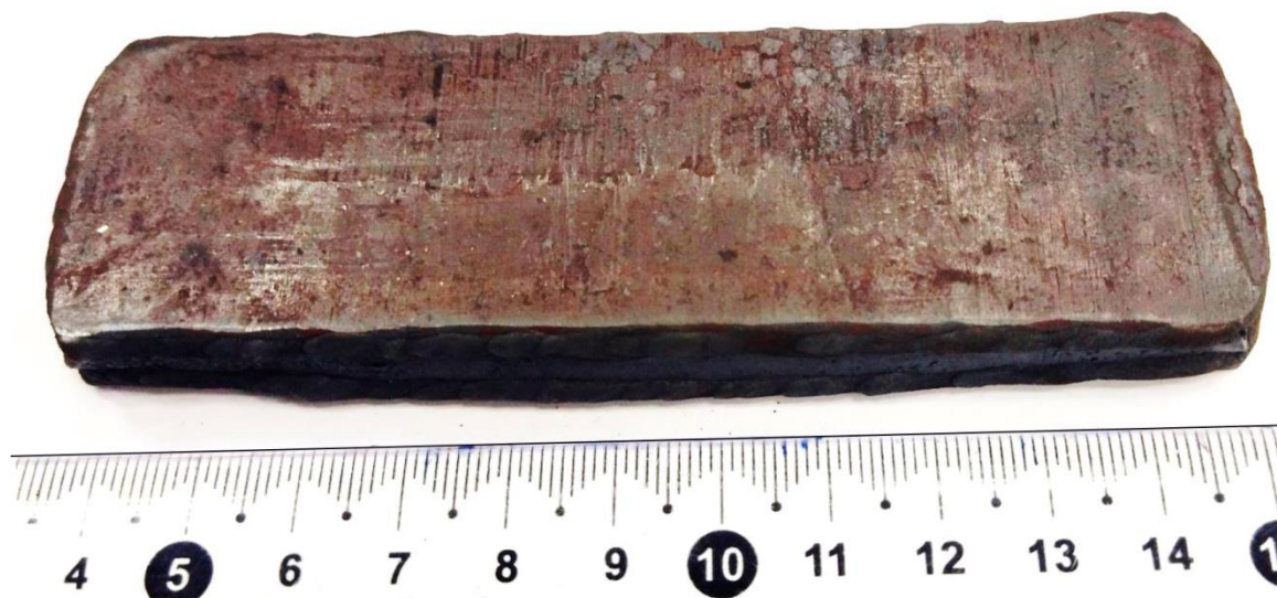
Рис. 3. Внешний вид образца в оболочке после прокатки
